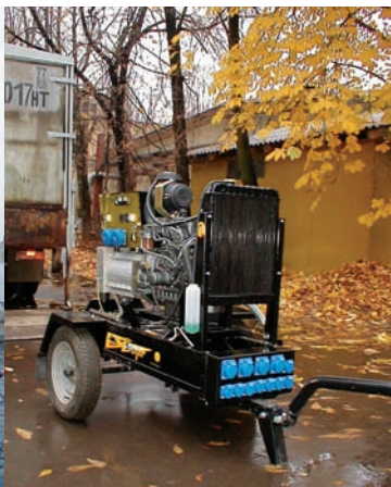
АДА 25-230 РЛ изготовлен с расширенной системой отбора мощности для связистов.
